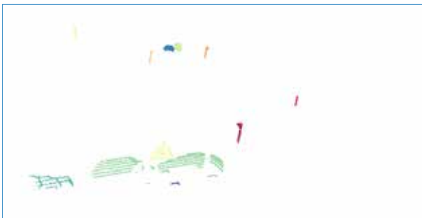
Segmentierung der Punktwolke in einzelne Objekte
